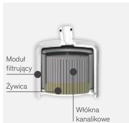
Przekrój głowicy filtrującej BIOFIL
