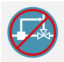
Zakaz robienia by-passów na instalacji
