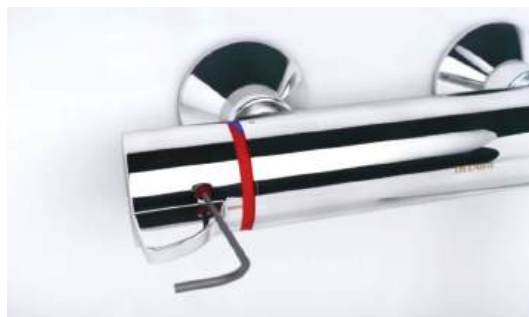
Odblokowanie ogranicznika temperatury przy dezynfekcji termicznej: wystarczy szpiczastym narzędziem wcisnąć czerwony przycisk
