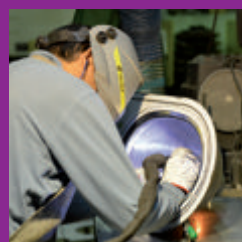
Spawanie urządzeń sanitarnych z Inoxy Fabryka DELABIE w Aveiro, Portugalia
