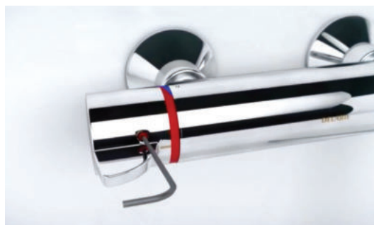
Odblokowanie ogranicznika temperatury celem realizacji dezynfekcji termicznej: wystarczy wcisnąć czerwony przycisk ostrym narzędziem.
